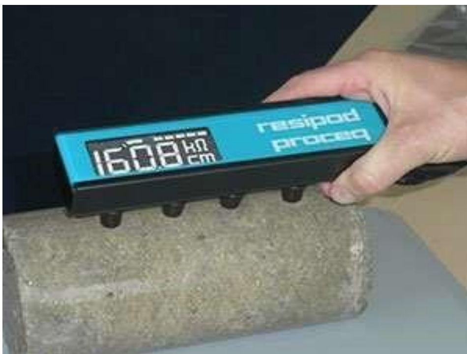
شکل ۲-۱۶ اندازه گیری مقاومت الکتریکی بتن به وسیله دستگاه دستگاه الکتریک سنج
