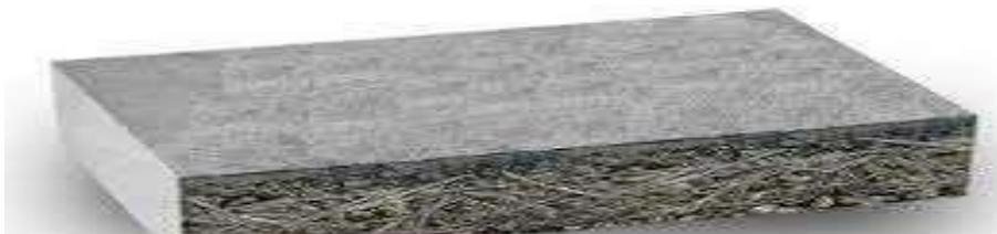
شکل ۴۷-۲ عدم وجود ترک در نمونه بتن الیافی، پس از انجام آزمایش ضربه (پس از ۹۵ ضربه)
