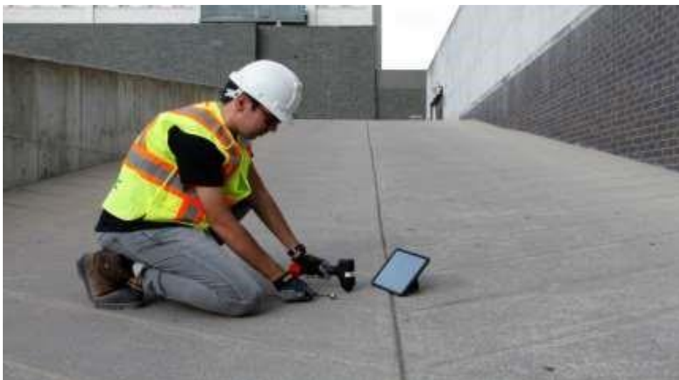
شکل ۲-۳۲ شناسایی فضای خالی درون بتن به وسیله دستگاه VIE
