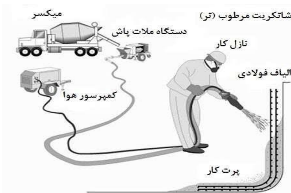
شکل ۲-۲۸ نحوه انجام شاتکریت مخلوط مرطوب (تر)
