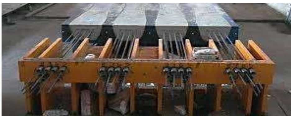
شکل ۲-۴۳ نحوه ساخت بتن پیش تنیده جهت احداث سطوح
