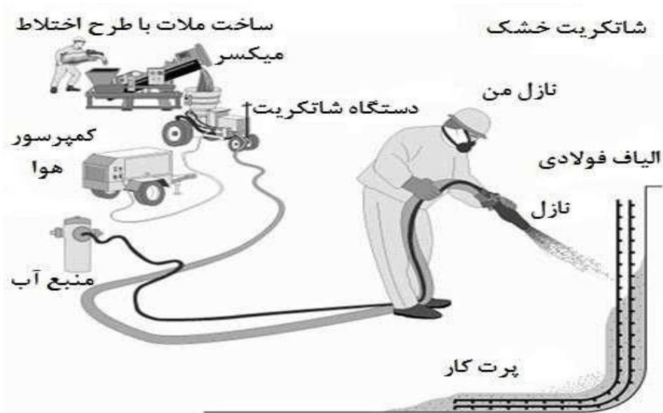
شکل ۲-۲۹ نحوه انجام شاتکریت مخلوط خشک
