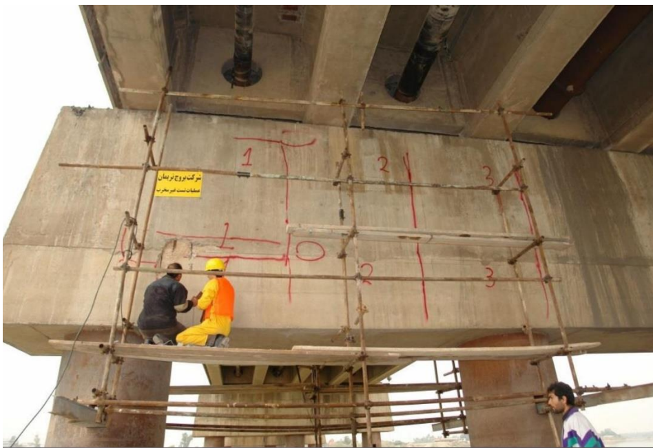
بررسی میزان خوردگی با هالف سل یا CANIN
