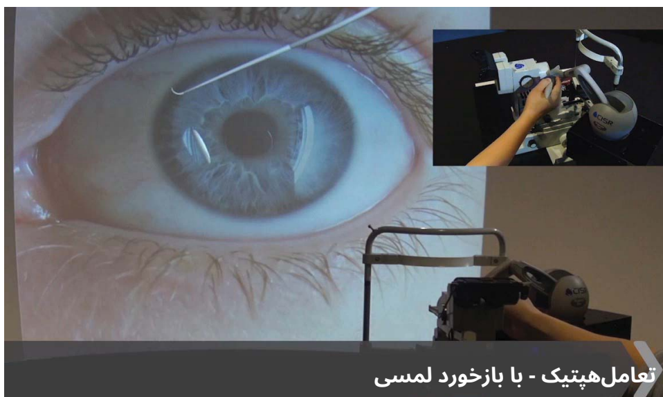
شکل 9.3 سیستم SimOptIX در حال عمل است. دوربین های متعددی برای عکسبرداری از نمای کلی سیستم و عملیات دقیق استفاده شده است.
