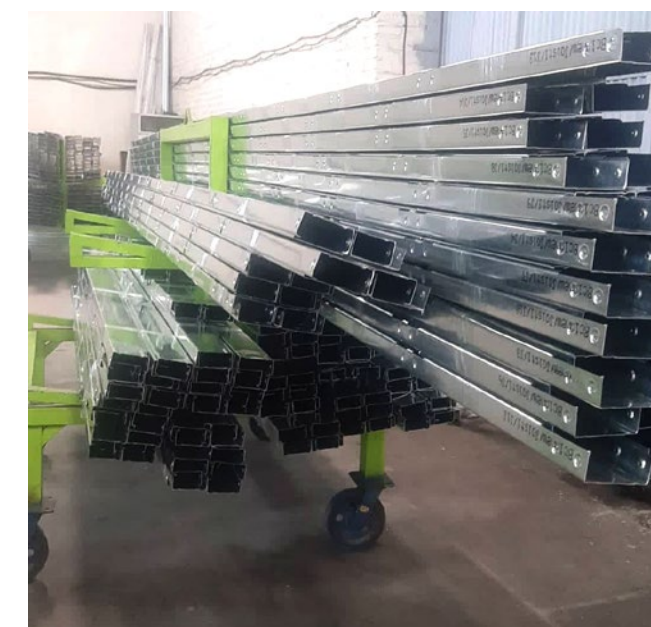
پروفیل‌های برش و شماره خورده آماده ارسال برای نصب در محل سفارش
