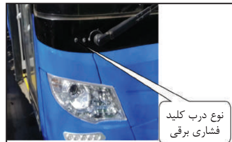
شکل ۳-۴ کلید فشاری درب برقی
