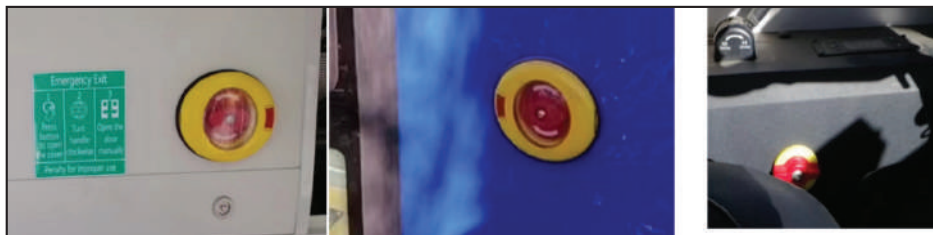
کلید سوپاپ اضطراری در کابین رانندگی. کلید سوپاپ اضطراری داخلی و خارجی شکل ۳-۳ کلید سوپاپ اضطراری
