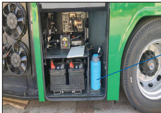
کپسول آتشی اتوماتیک درون کابین موتور
