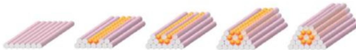
شکل ۳-۹ قالب طراحی سازه های تیوبی شکل (رنگ صورتی: میله های آگارز؛ رنگ نارنجی: واحدهای استوانه ای جوهر زیستی)
