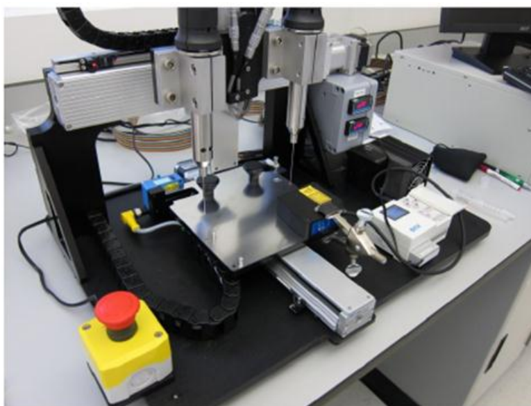
شکل ۳-۴: چاپگر زیستی ایم ایم ایکس نووژن، ساخت شرکت آرگانووو
